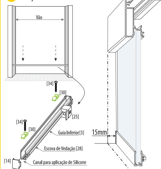
Confira as medidas dos vidros e do vão. Atenção ao nível e prumo. Corte o Perfil Guia [3] 3mm menor que o vão. Faça 2 furos com o Ø 4mm para fixar e 3 furos para escoamento da água. Coloque a Escova de Vedação [28], os Batentes com Aba [25] e os Acabamentos da Guia [14]. Parafuse [34], utilizando os protetores [30].
