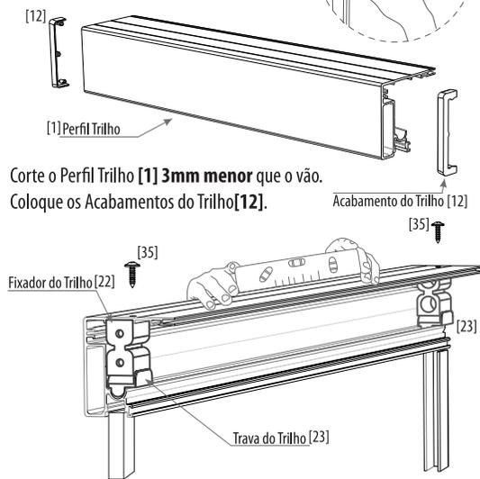
Corte o Perfil Trilho [1] 3mm menor que o vão. Coloque os Acabamentos do Trilho [12]. Coloque o Conjunto do Trilho com os Acabamentos [12] nos Fixadores [22], encaixe a Trava do Trilho [23]. Verifique o nivelamento de todo o conjunto e trave o sistema utilizando os parafusos [35].
