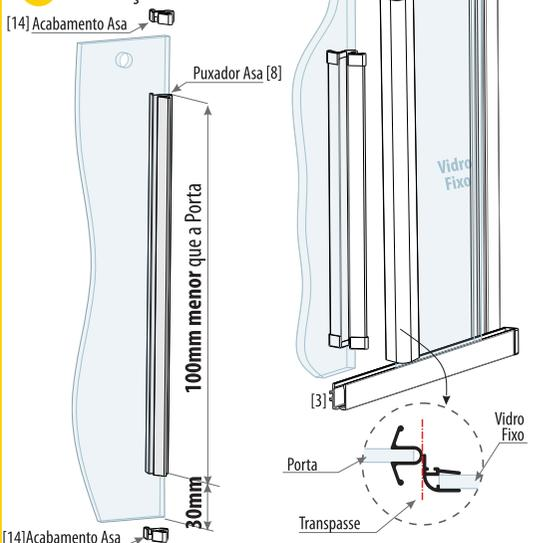
Corte o Puxador Asa [8] 100mm menor que a altura da porta e aplique o silicone. Cole o Puxador Asa [8] 30mm acima da borda inferior da porta. Coloque os Acabamentos Asa [14]. Encaixe Perfil H de Canto [11] na borda do Vidro Fixo. Fixe o Batente com Aba [24], após ajustar a parada de fechamento e abertura. **Atenção:** Puxador Asa [8] não pode atritar no Perfil Guia [3] e Perfil Trilho [1].
