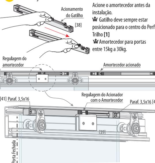
Posicione o Amortecedor [38] no Trilho [1], com o gatilho voltado para o centro do Perfil. Regule o Acionador [39] com o Amortecedor [38]. Engate a porta no gatilho do acionador e posicione a parada de fechamento. Fixo-o amortecedor. Repita o processo posicionando a parada de abertura.
