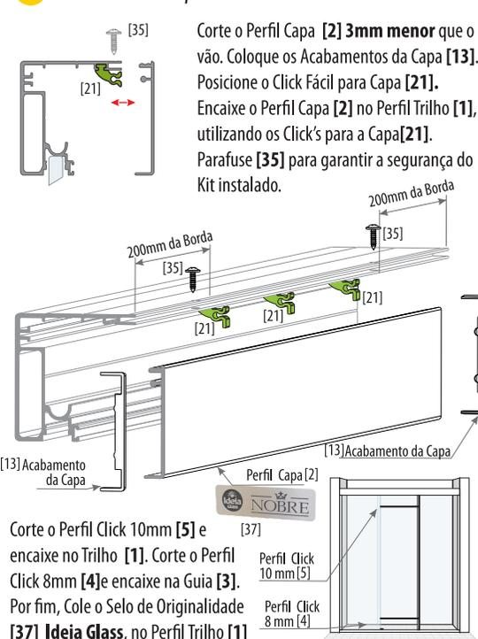
Corte o Perfil Click 10mm [5] e encaixe no Trilho [1]. Corte o Perfil Click 8mm [4] e encaixe na Guia [3]. Por fim, Cole o Selo de Originalidade [37] Ideia Glass, no Perfil Trilho [1]
