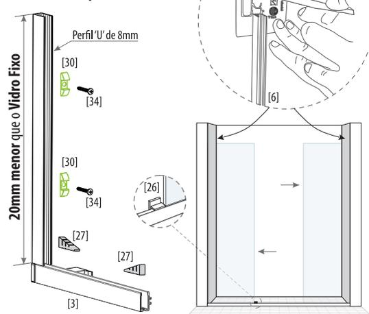
Corte o Perfil 'U' de 8mm [6] 20mm menor que o Vidro Fixo, parafuse [34] utilizando os protetores de parafusos [30] e vede. Encaixe os Vidros Fixos no Perfil Guia [3] e ajuste o nível com a Cunha de Regulagem [27]. Coloque a Guia de Nylon [26] e trave os Vidros com o Perfil Camaleão [29].
